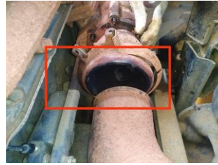
Proses pelepasan exhaust break
