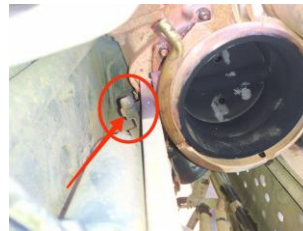
Terlihat shaft flap patah
