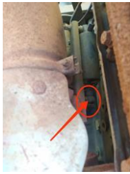
Shaft flap terlihat patah
