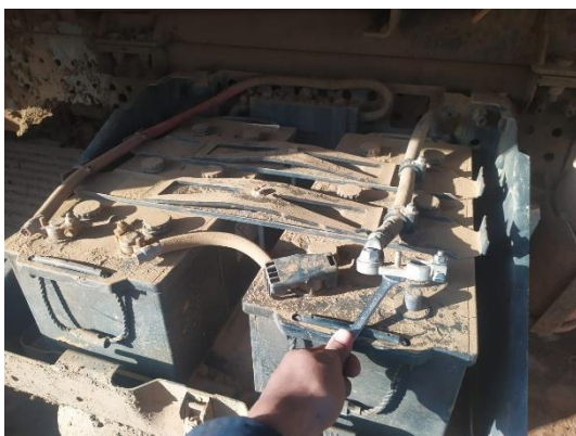
Proses pelepasan pada terminal min (-) baterai
