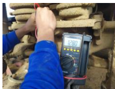
mengukur tahanan sensor (1.280 ohm) (OK)
