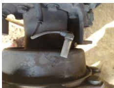
mengukur tahanan sensor (1.280 ohm) (OK)
