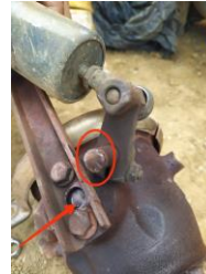
shaft flap terlihat jelas patah
