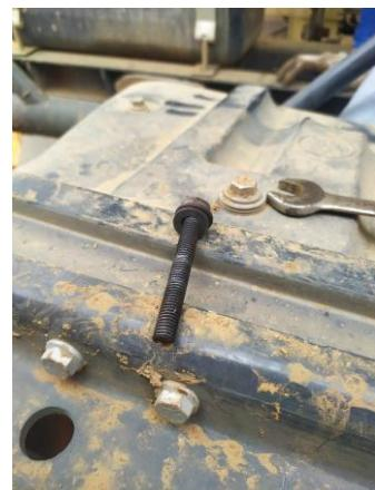
RESULT : OPERATOR MELAPORKAN BAHWA EXHAUST BREAK TIDAK BERFUNGSI. LALU SAYA MENGETES DAN MENGECEK SILINDER EXHAUST BREAK AKTIF BEROPERASI ATAU TIDAK. SETELAH DICEK TERNYATA SILINDER EXHAUST BREAK LEPAS DARI BRACKET NYA DAN BAUT NYA PATAH. KEMUDIAN SAYA MEMPERBAIKI DAN MENGGANTI BAUT YANG PATAH PADA BRACKET SILINDER EXHAUST BREAK.
