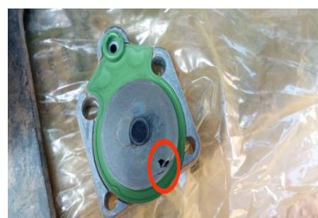
RESULT : OPERATOR MELAPORKAN BAHWA EXHAUST BREAK TIDAK BERFUNGSI. LALU SAYA MENGETES DAN MENGECEK SILINDER EXHAUST BREAK AKTIF BEROPERASI ATAU TIDAK, TERNYATA TIDAK. KEMUDIAN SAYA MENGECEK DAN MEMBONGKAR SELENOID EXHAUST BREAK DAN DITEMUKAN PLAT PENEKAN TERJADI KERUSAKAN. SETELAHNYA SAYA PERBAIKI DENGAN MEMBUAT PLAT PENEKAN YANG BARU DAN HASILNYA EXHAUST BREAK KEMBALI BERFUNGSI SEBAGAIMANA MESTINYA.
